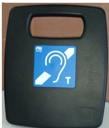
Rysunek 2. System wspomaganie słuchu z pętlą indukcyjną
